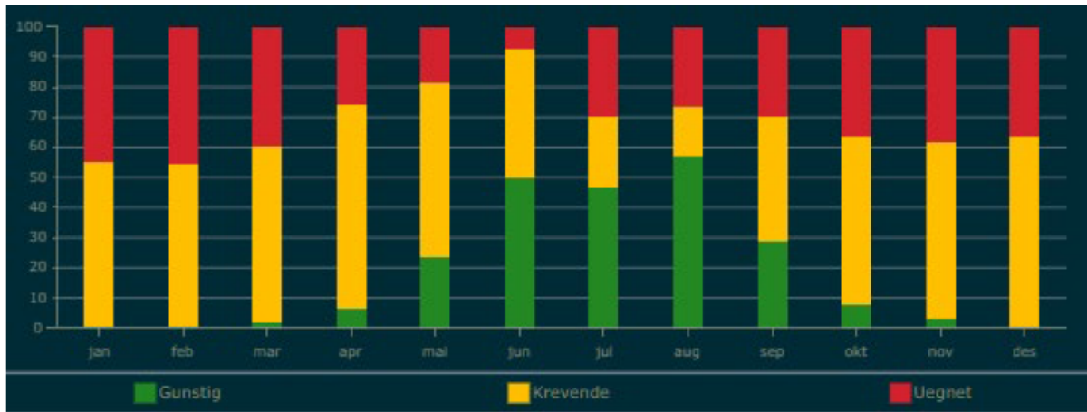
Figur 2 Figur 7-16 fra Equinor sin beredskapsanalyse 8 , som viser operasjonsvinduet for mekanisk bekjempelse av et oljeutslipp. Tilsvarende figurer er laget for dispergering fra fartøy, dispergering fra fly, og in-situ brenning.
